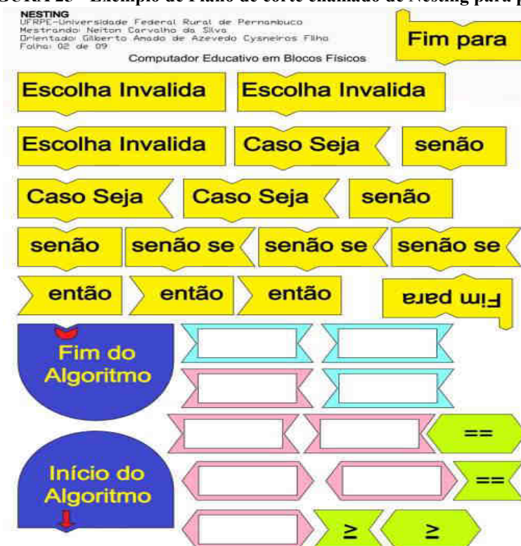
FIGURA 25 - Exemplo de Plano de corte chamado de Nesting para produção
